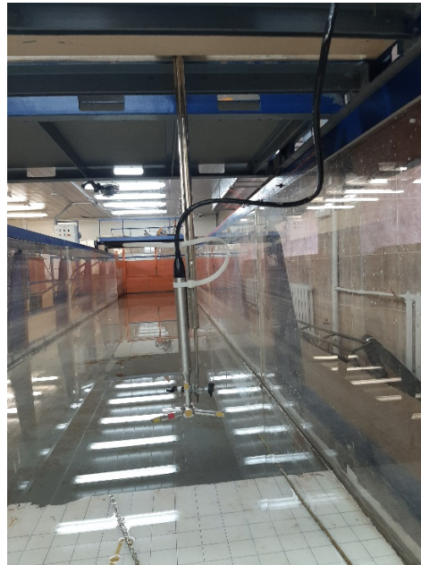
Рисунок 3.15 - Подвижная платформа, установленная на стенках гидравлического лотка. К платформе крепилась штанга с укрепленным измерителем скорости воды в лотке. Штанга имела возможность перемещения по вертикали
