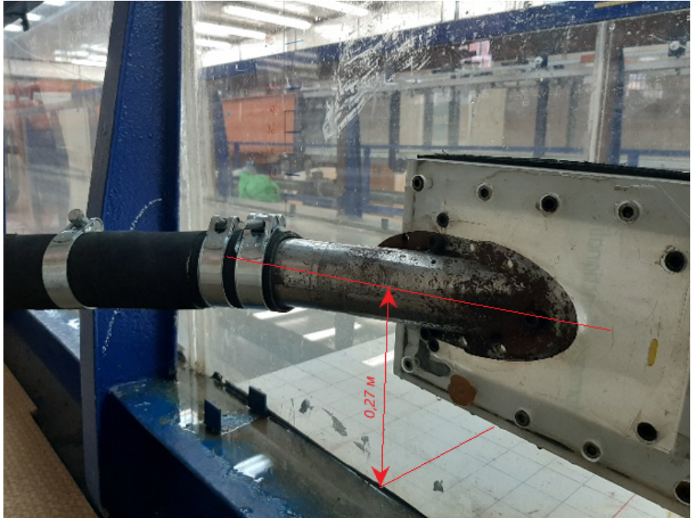
Рисунок 3.3 - Модель канала с закручивающим устройством внутри, прикреплённый к боковой стенке гидравлического лотка. Расстояние от оси патрубка до дна лотка – 0,27 м. Закручивающее устройство шнекового типа не видно. Оно находится в чёрном резиновом подводящем шланге
